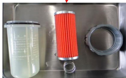
燃料フィルターを分解した様子
