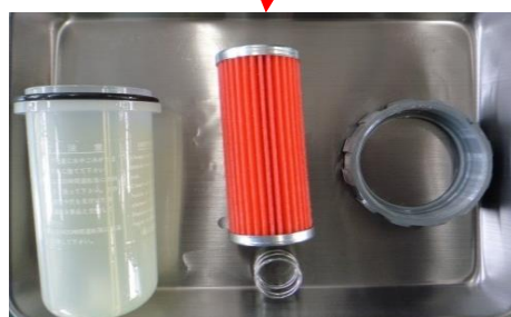
燃料フィルターを分解した様子
